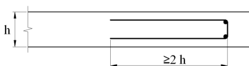
Рисунок 9.15 – Краевая арматура плиты
